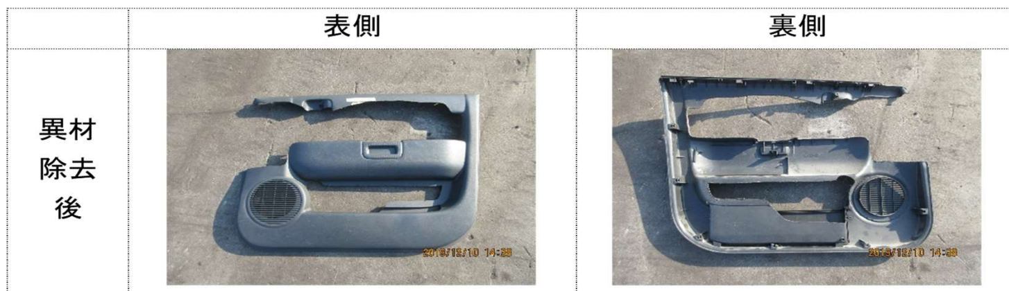
モケット及び吸音材を取付けている接着剤の除去は完全には出来ないため、接着部をエアソーで切断除去した
