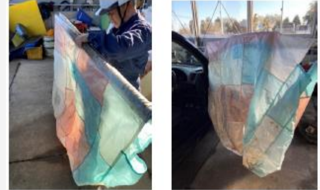
エアバック布を用いたサイドガラス回収治具の例
