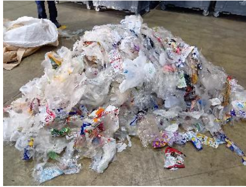
図 22 光学選別機を 6 台通過させた容器包装プラスチック
