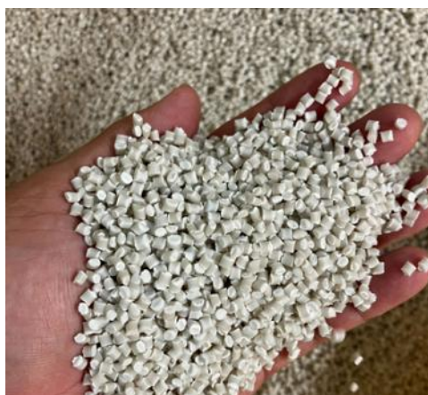
図 37 プラダンボールの改質後のペレットの様子
