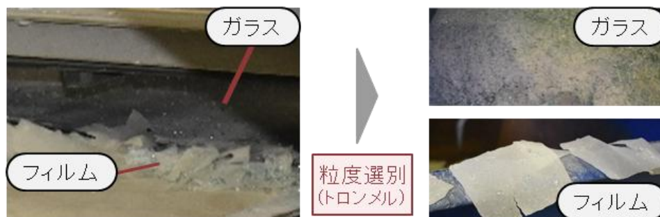
図 2-20 トロンメルへの投入状況（左）と回収したガラスと中間膜（右） 出所）三菱UFJリサーチ&コンサルティング株式会社撮影
