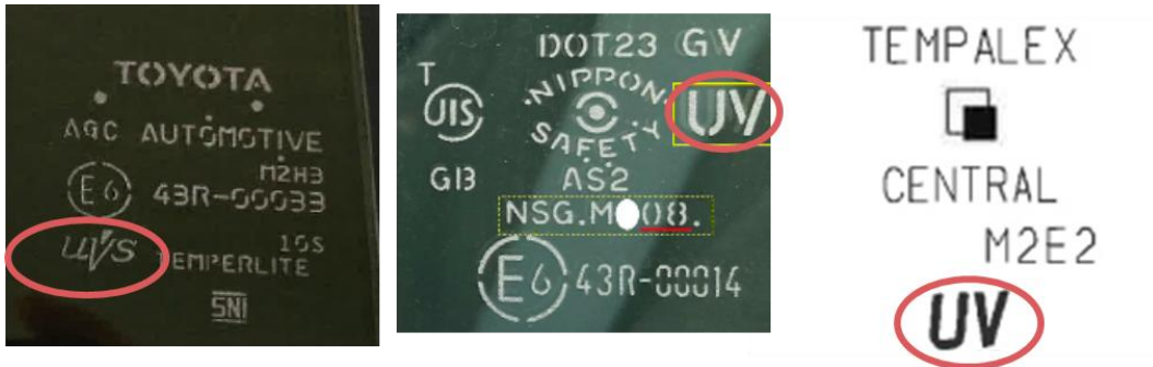
図 2-9 UV カット機能を示す記号 出所) 一般社団法人板硝子協会提供資料をもとに三菱 UFJ リサーチ&コンサルティング株式会社作成
