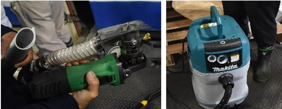
図 2-3 フロントガラス切断に用いたガラスカッター（左）と使用した集塵機（右） 出所）三菱 UFJ リサーチ&コンサルティング株式会社撮影
