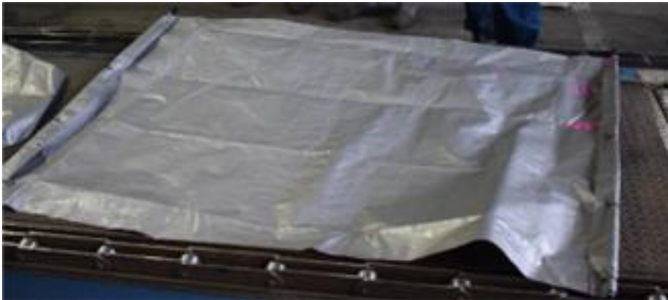
図 2-7 サイドガラス用のガラス回収シート 出所) 三菱UFJリサーチ&コンサルティング株式会社撮影
