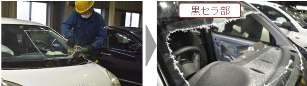
図 2-5 フロントガラス切断の様子(左)と切断後の状態(右) 出所) 三菱UFJリサーチ&コンサルティング株式会社撮影
