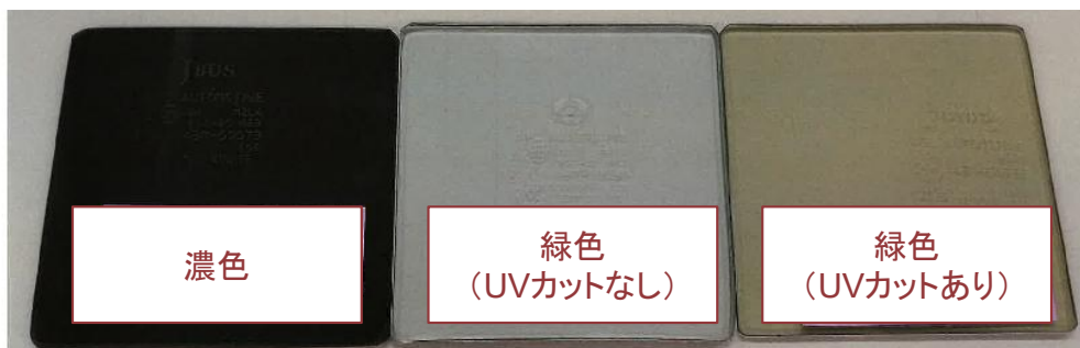
図 2-8 サイドガラスの着色 出所) 一般社団法人板硝子協会提供資料をもとに三菱UFJリサーチ&コンサルティング株式会社作成
