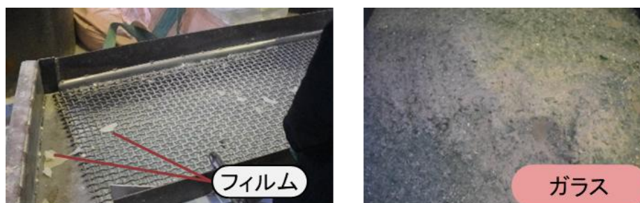
図 2-21 篩分け（左）により得られたフロントガラス由来のカレット（右） 出所）三菱 UFJ リサーチ&コンサルティング株式会社撮影
