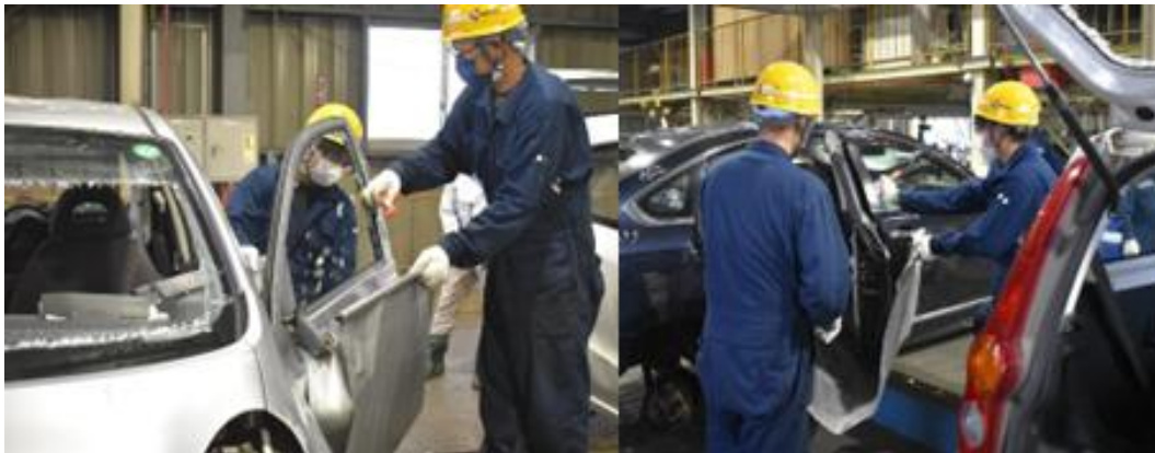
図 2-10 サイドガラスの破碎と回収の様子 出所) 三菱 UFJ リサーチ&コンサルティング株式会社撮影
