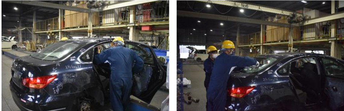
図 2-14 シートの設置（左）とリアガラスの破碎（右）
