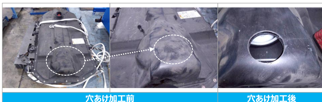
図 2-19.LiB への穴あけ加工（エコアール試験）
