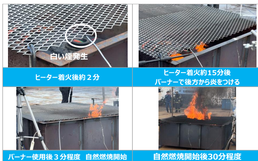
図 2-69.角型 LiB の燃焼挙動確認の様子
