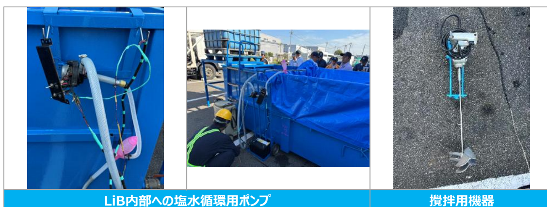
図 2-20.ポンプおよび攪拌用機器（エコアール試験）
