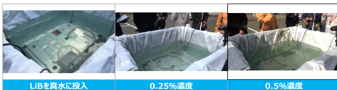
図 2-32. 塩水放電時の様子 (L、0.25%、0.5%濃度) (西日本オートリサイクル試験)
