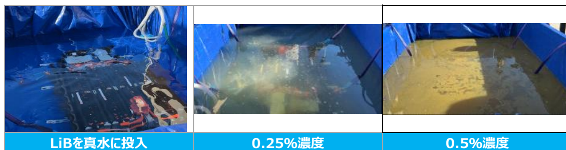
図 2-40. 塩水放電時の様子（L、0.25%、0.5%濃度）（テラダパーツ試験）
