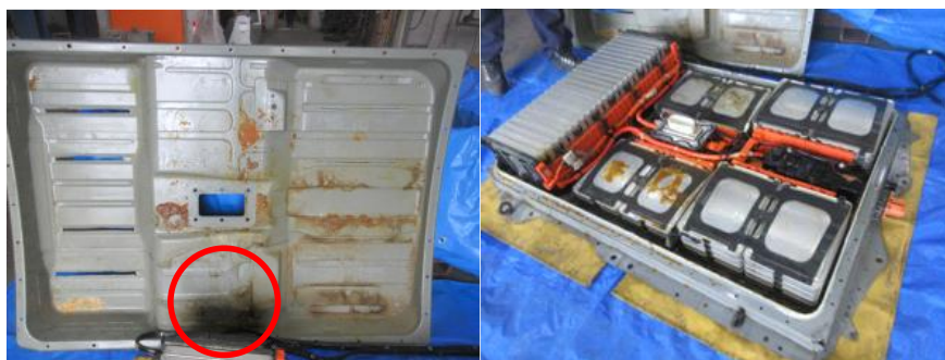
図 2-10.塩水からの引き上げ、アッパーカバー取り外し後の LiB の様子 (1%塩水濃度)
