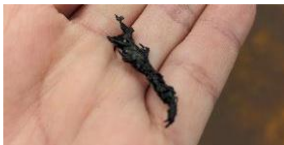
図 2-70.飛散したアッパーカバー
