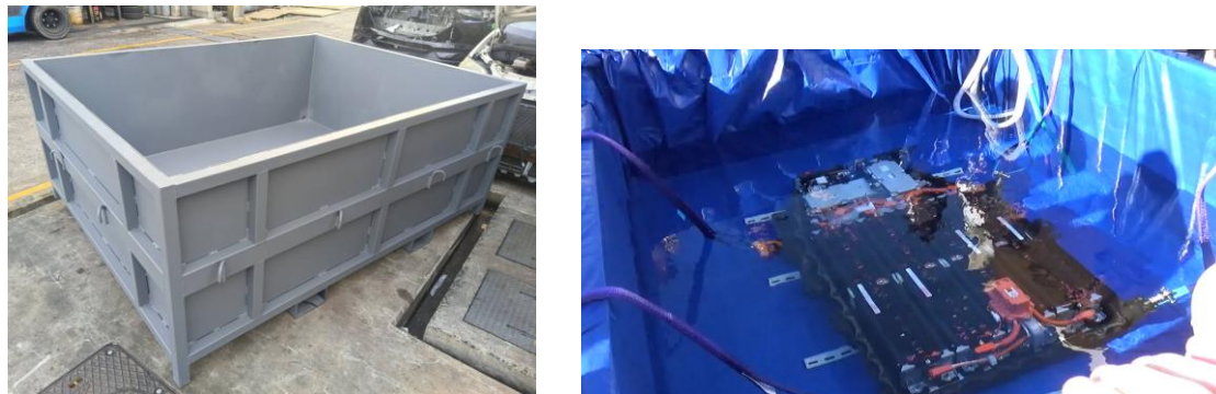
図 2-39.塩水放電用の水槽と LiB 設置状況（テラダパーツ試験）
