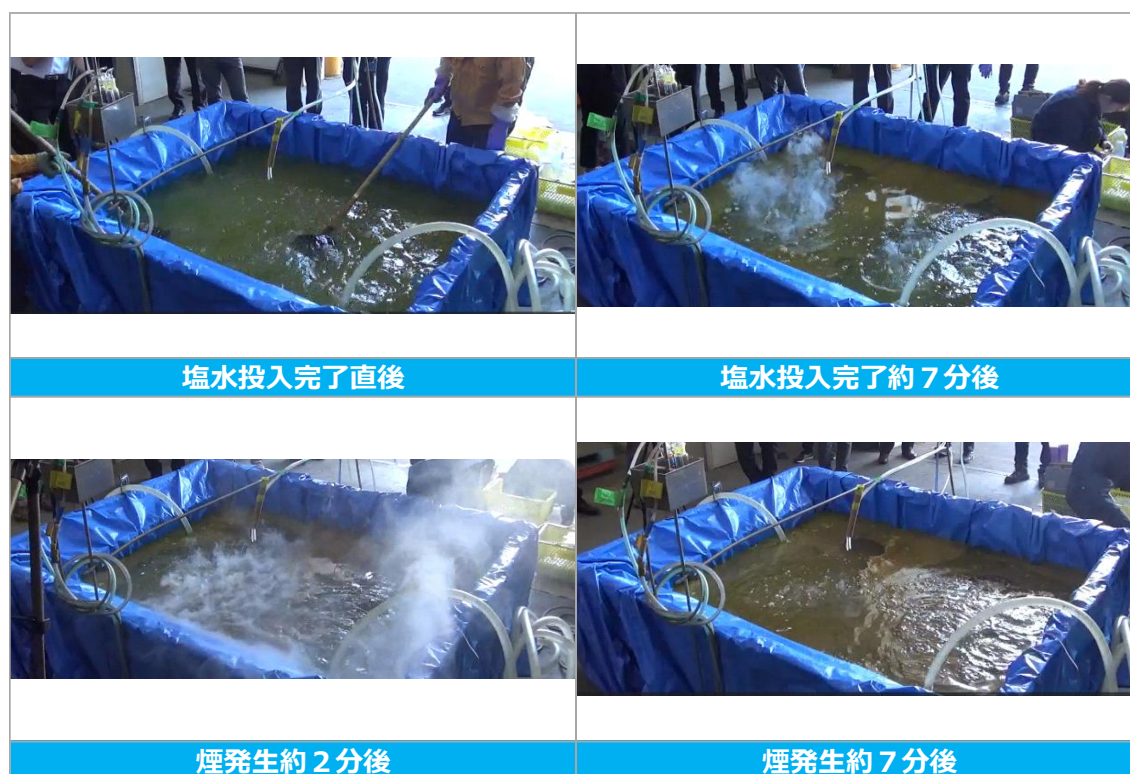
図 2-7.塩水放電時の様子 (LL、1%濃度)
