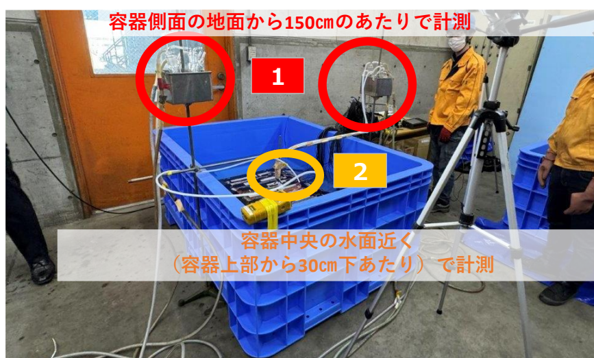
図 2-12.発生ガス測定箇所
