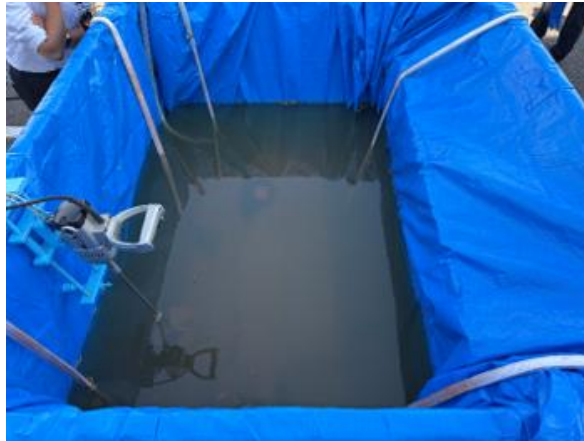
図 2-24.24 時間後の LiB の様子 (L、0.5%濃度) (エコアール試験)
