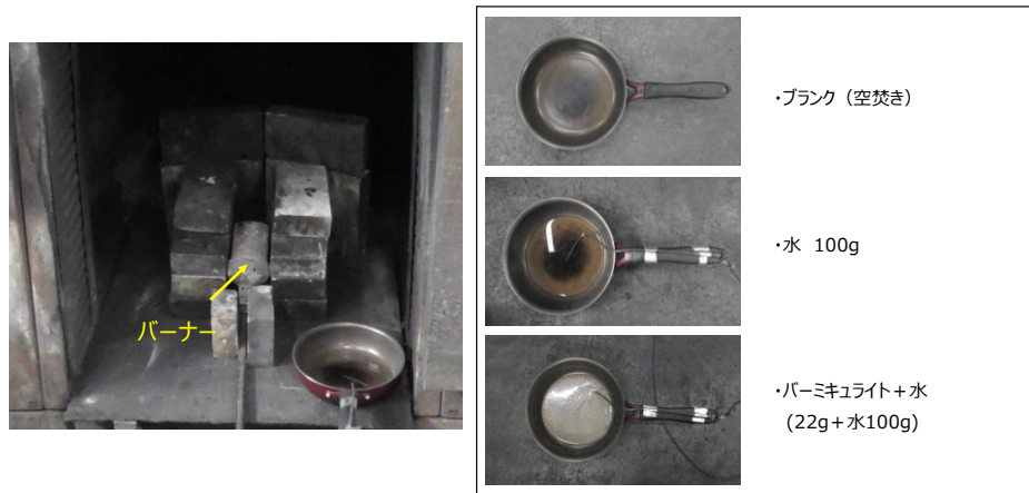
図 2-88.バーミキュライト昇温抑制効果の確認（実験風景及び共試サンプル）
