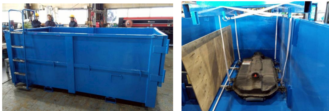
図 2-22.塩水放電用の水槽と LiB 設置状況（エコアール試験）
