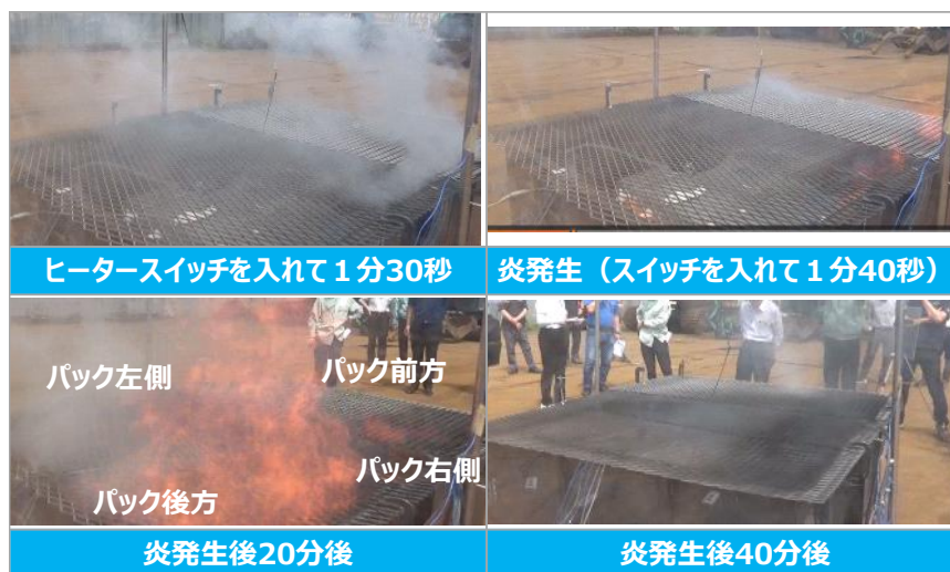
図 2-57.ラミネート LiB の燃焼挙動確認の様子
