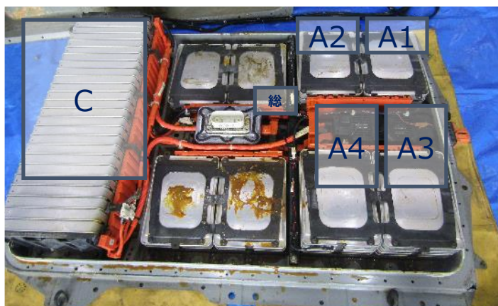
図 2-11.電圧測定箇所
