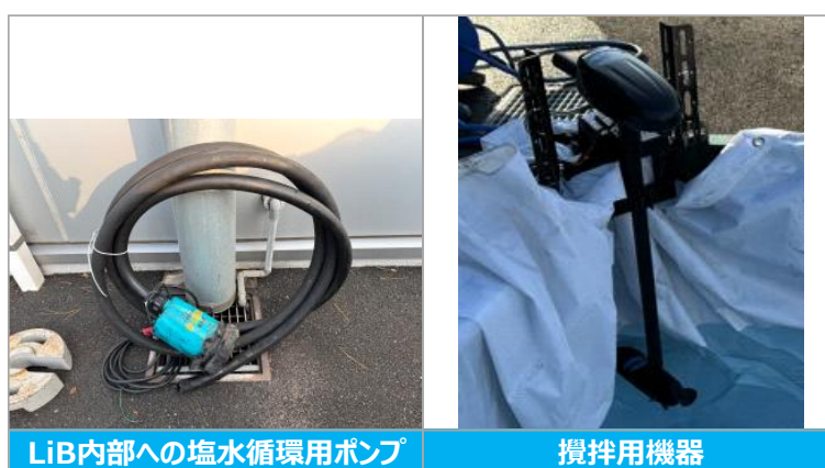
図 2-28.ポンプおよび攪拌用機器（西日本オートリサイクル試験）
