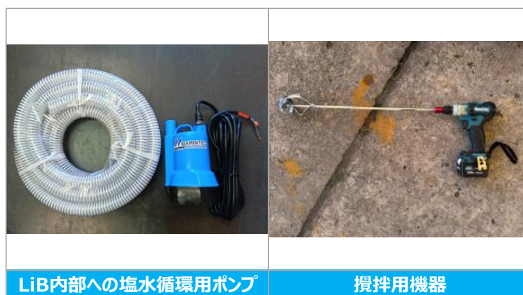
図 2-36.ポンプおよび攪拌用機器
