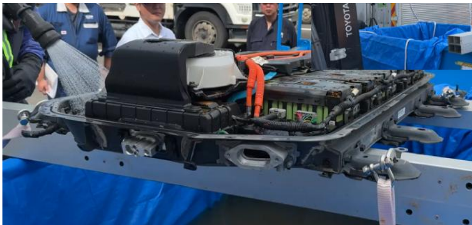
図 2-25.洗浄作業の様子 (L、0.5%濃度) (エコアール試験)
