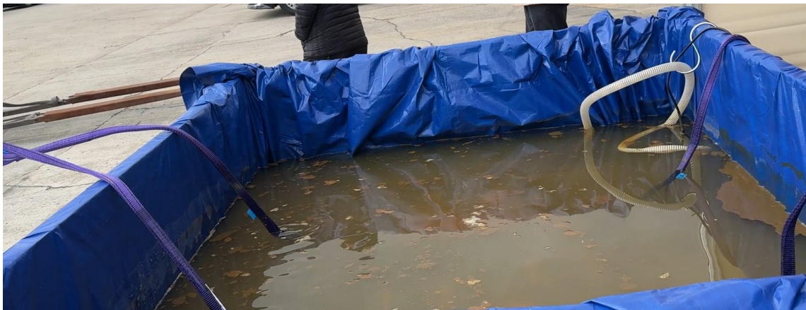
図 2-41.24 時間後の LiB の様子 (L、0.5%濃度) (テラダパーツ試験) 出所：テラダパーツ
