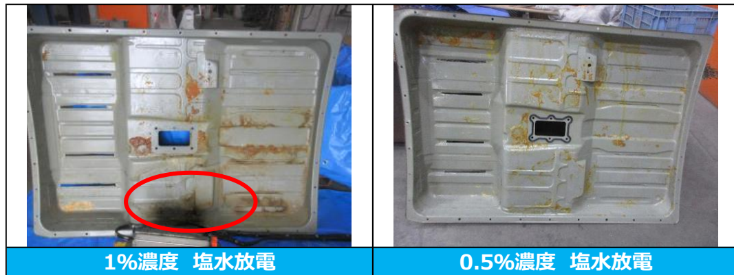
図 2-17.塩水からの引き上げ後、アッパーカバー取り外し後の LiB の様子（1%濃度、0.5%濃度比較）
