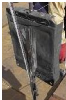
図 2-77.温度計を設置した鉄板
