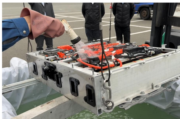
図 2-34.洗浄作業の様子 (L、0.5%濃度) (西日本オートリサイクル試験)
