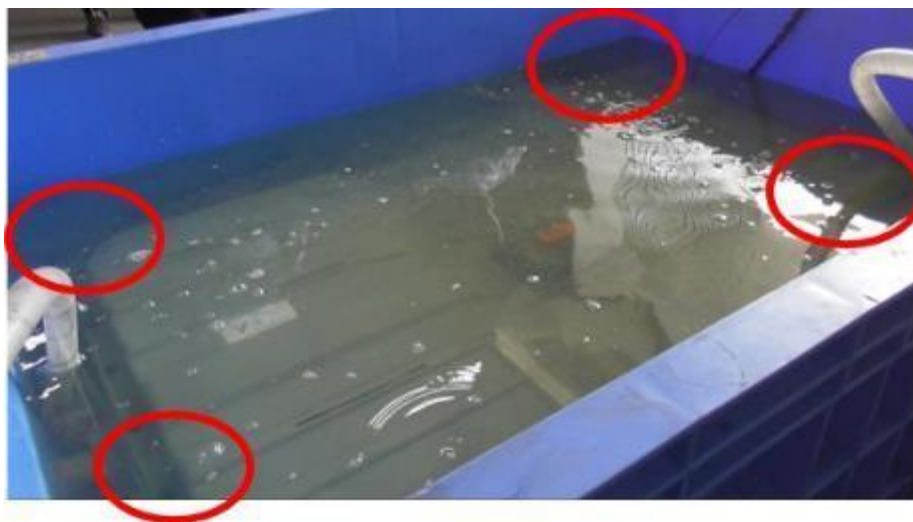
図 2-15. 塩水継ぎ足しごとに四隅の電気伝導度を測定
