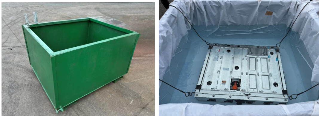
図 2-31.塩水放電用の水槽とLiB設置状況（西日本オートリサイクル試験）
