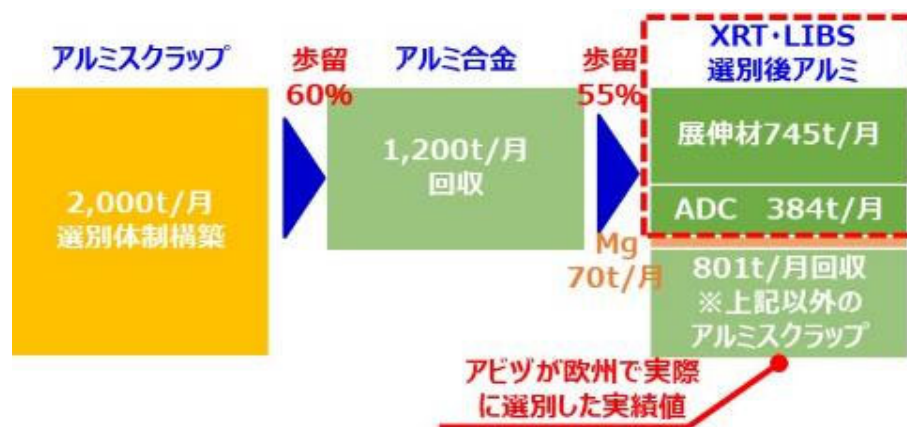
図 4-1. XRT・LIBS 選別フローによって得られる展伸材および ADC
