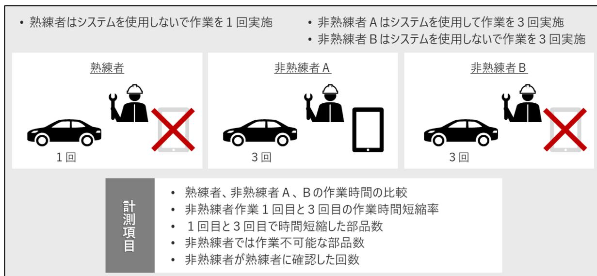
図 22 部品取り作業ガイドシステム 検証方法
