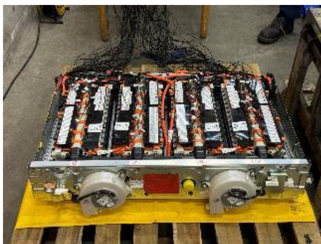
図 2-6. ロガー112 本が接続された LiB (L)
