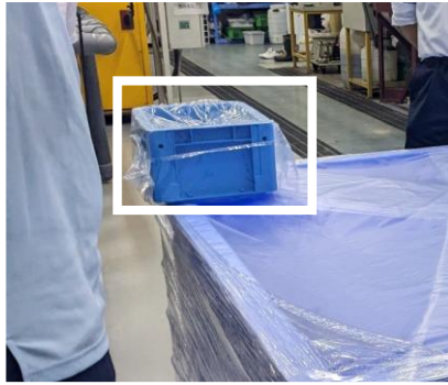
図 2-4.S 用塩水放電容器
