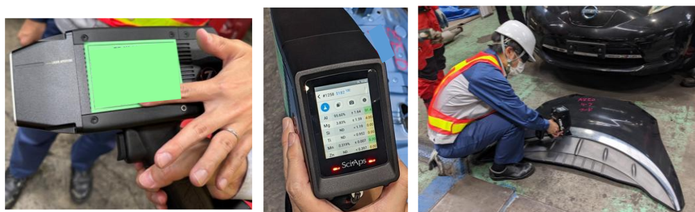
図 2-1.ハンディタイプの LIBS 測定装置と成分分析結果例と測定の様子
