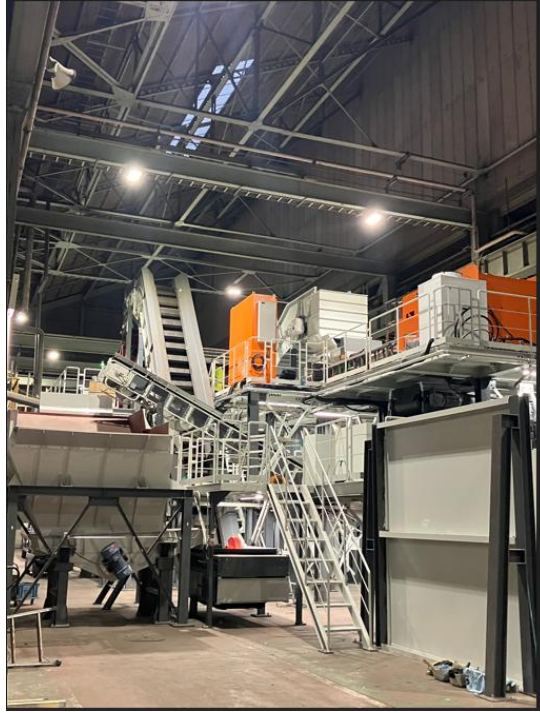
図 2-3. XRT・LIBS 選別装置外観 (アビヅ工場内)
