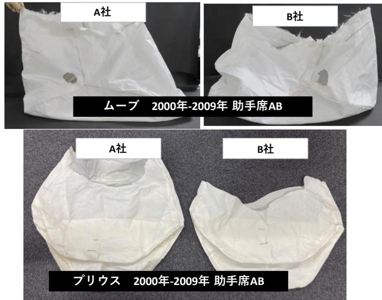
図 2-7. A 社および B 社の助手席エアバッグ布の回収品 (1 回目)
