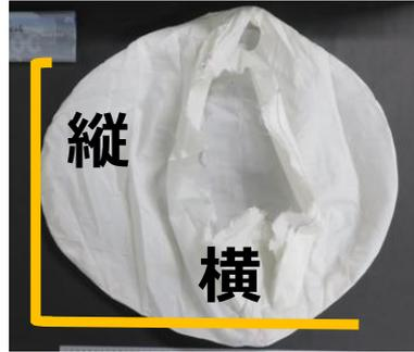
図 2-6. 助手席エアバッグ布の計測方法
