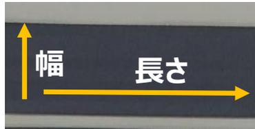
図 2-9.シートベルトの計測方法
