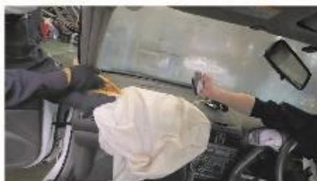
図.丸カッターによる回収の様子
