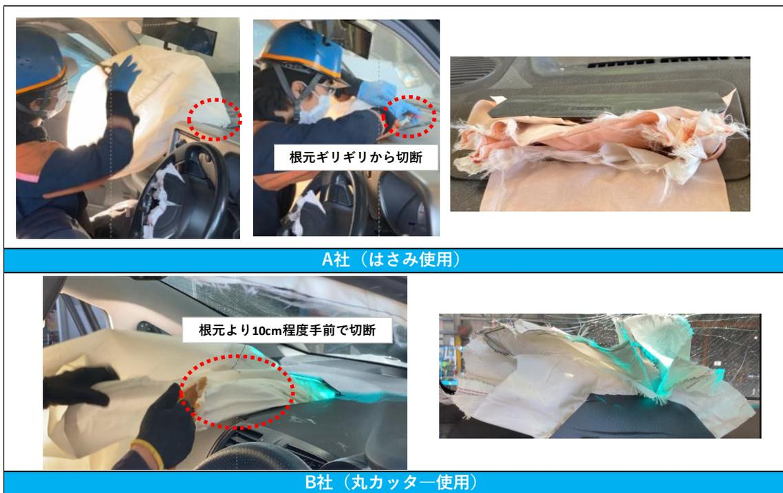
図 2-8. A 社および B 社の助手席エアバッグ布の回収方法と切断後のダッシュボード
