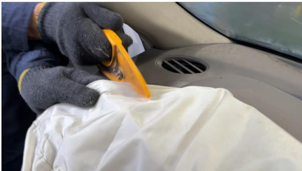
図.丸カッターによる回収の様子
