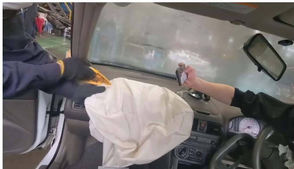
図.丸カッターによる回収の様子
