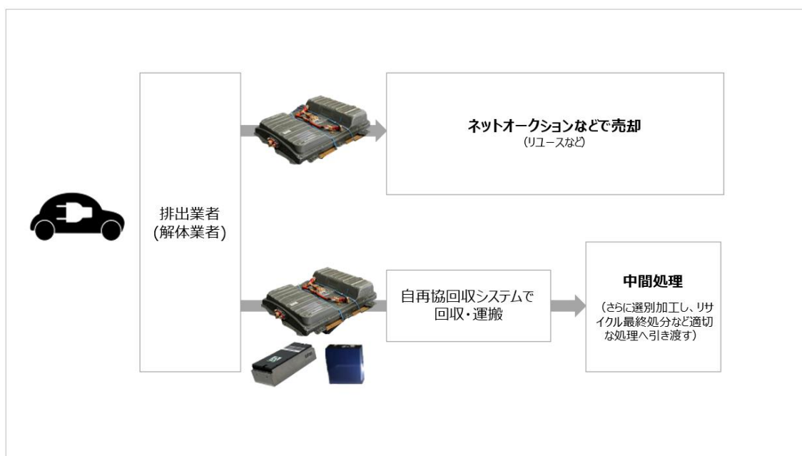
図 1 EV から解体された使用済みバッテリーのフロー概略図
