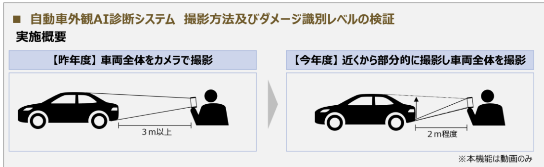
図 15 自動車外観 AI 診断システムの検証方法
