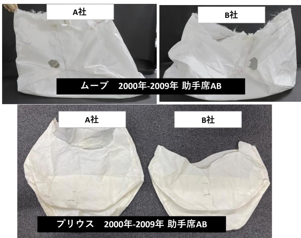
図 3-5. 助手席エアバッグ布の A 社および B 社の回収品 (1 回目)
