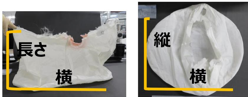
図 3-4. 助手席エアバッグ布の計測方法
