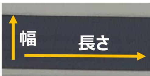
図 3-7.シートベルトの計測方法
