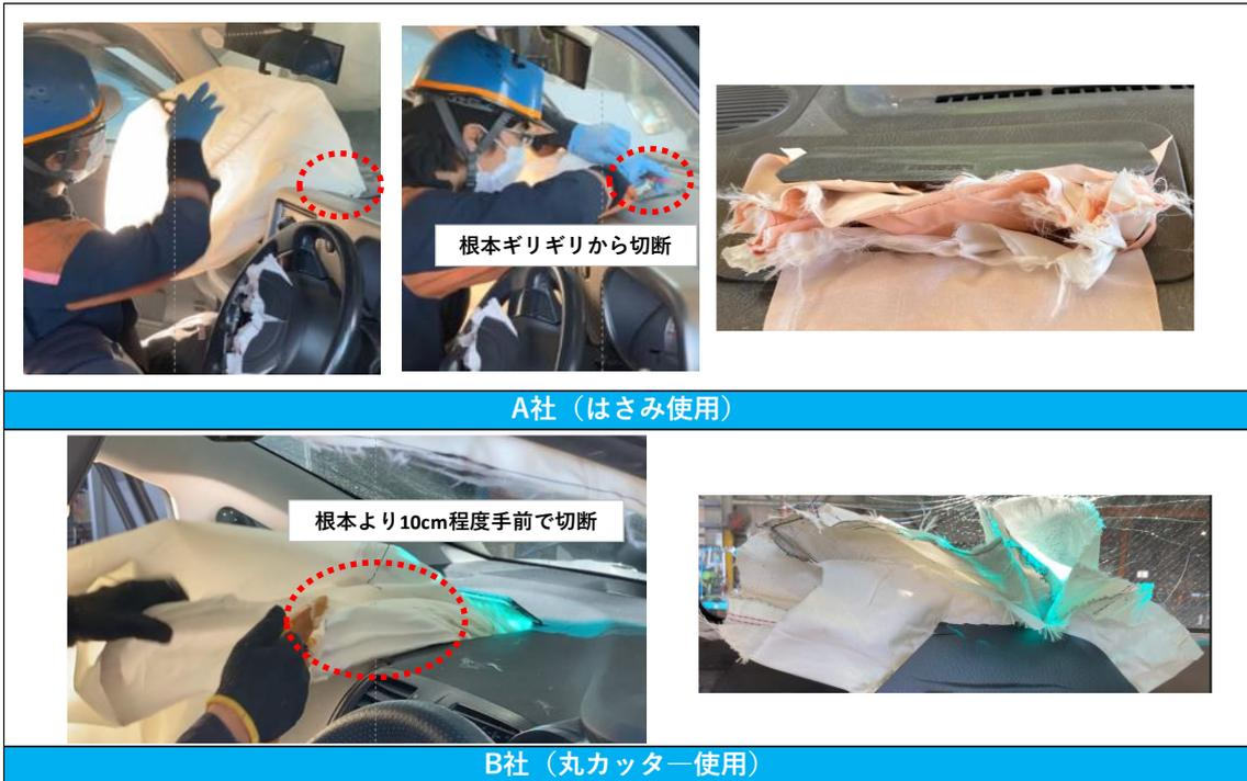
図 3-6.A 社および B 社の助手席エアバッグの回収方法と切断後のダッシュボード
