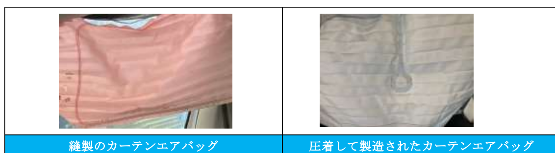
図 2-1.エアバッグの製造方法の違い
