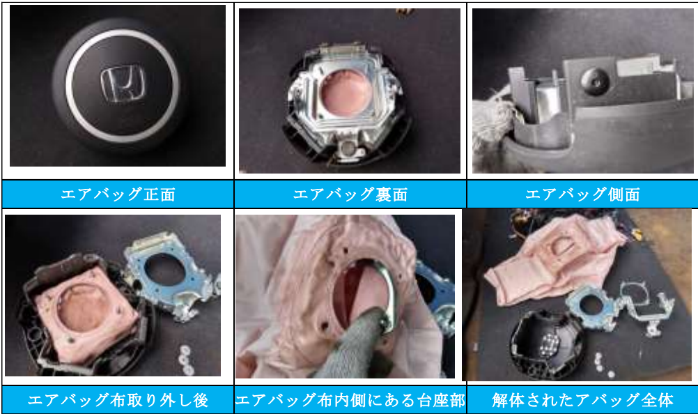
図 2-3.エアバッグの分解の様子 出所：エコアール撮影
