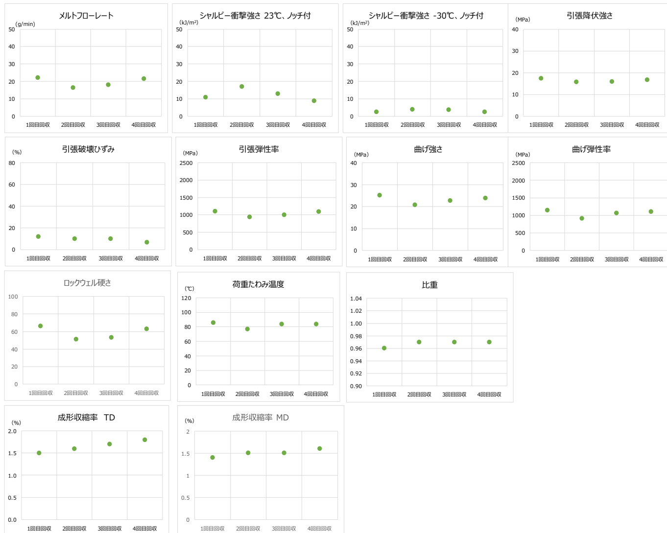
図.破砕事業者が回収した樹脂の物性測定結果
