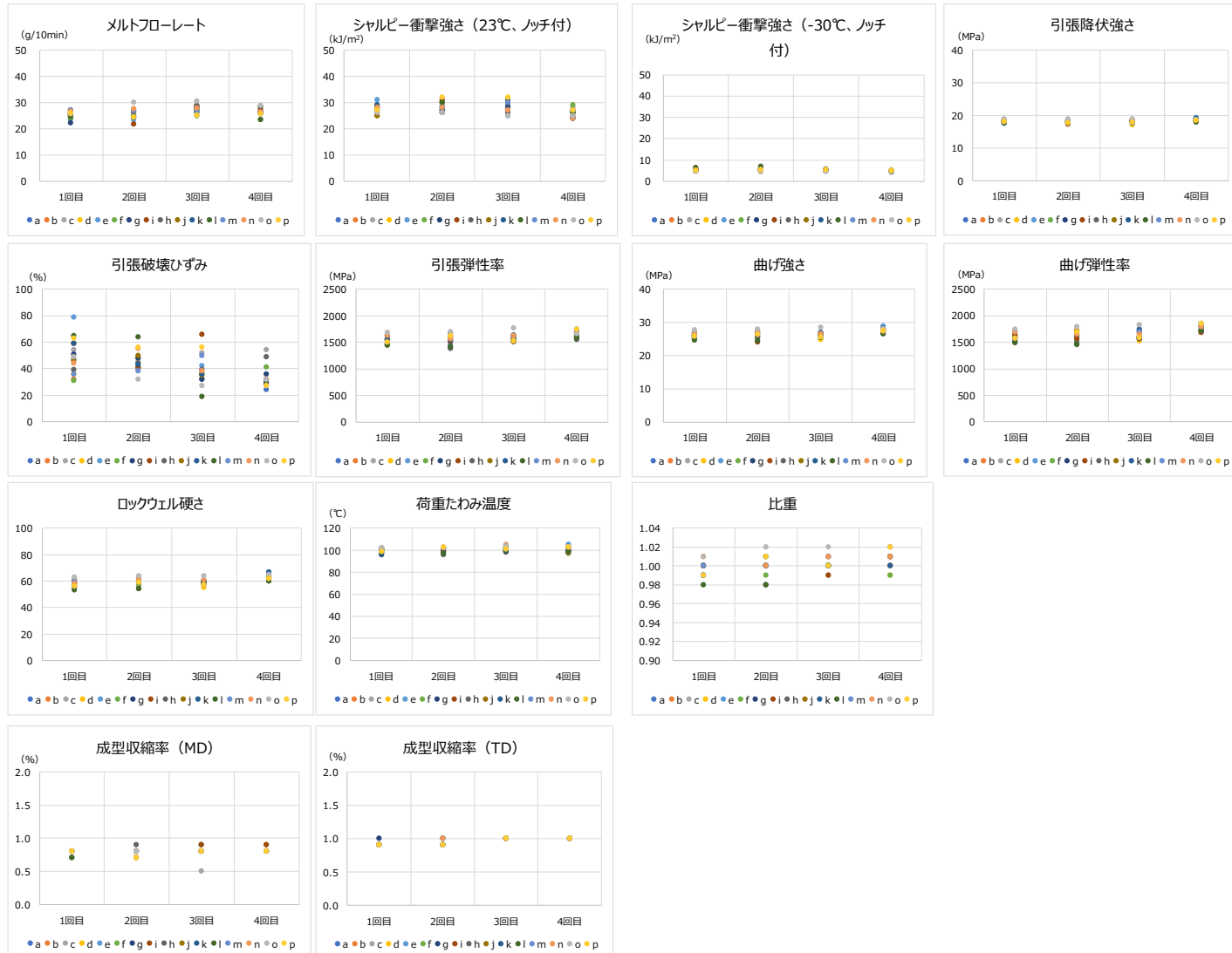
図.バンパーの物性測定結果
