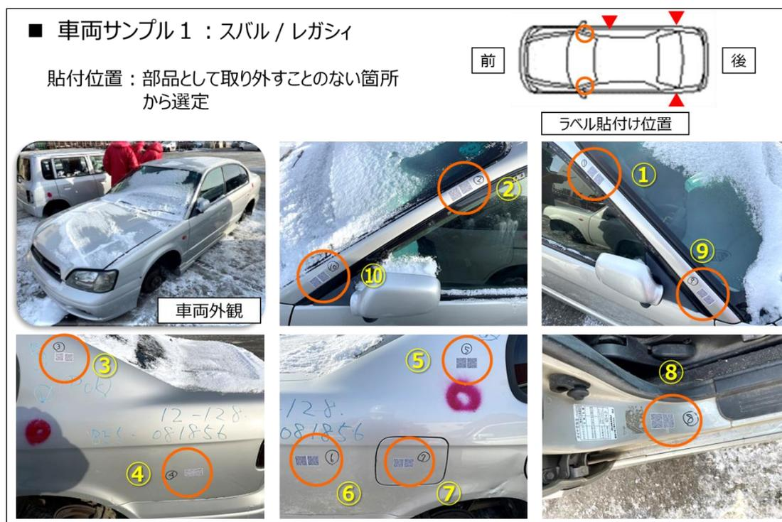
図 1 1 デジタルマーク（ラベル方式）貼付け状況
