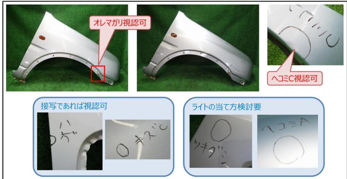
図 14 写真での傷の識別結果
