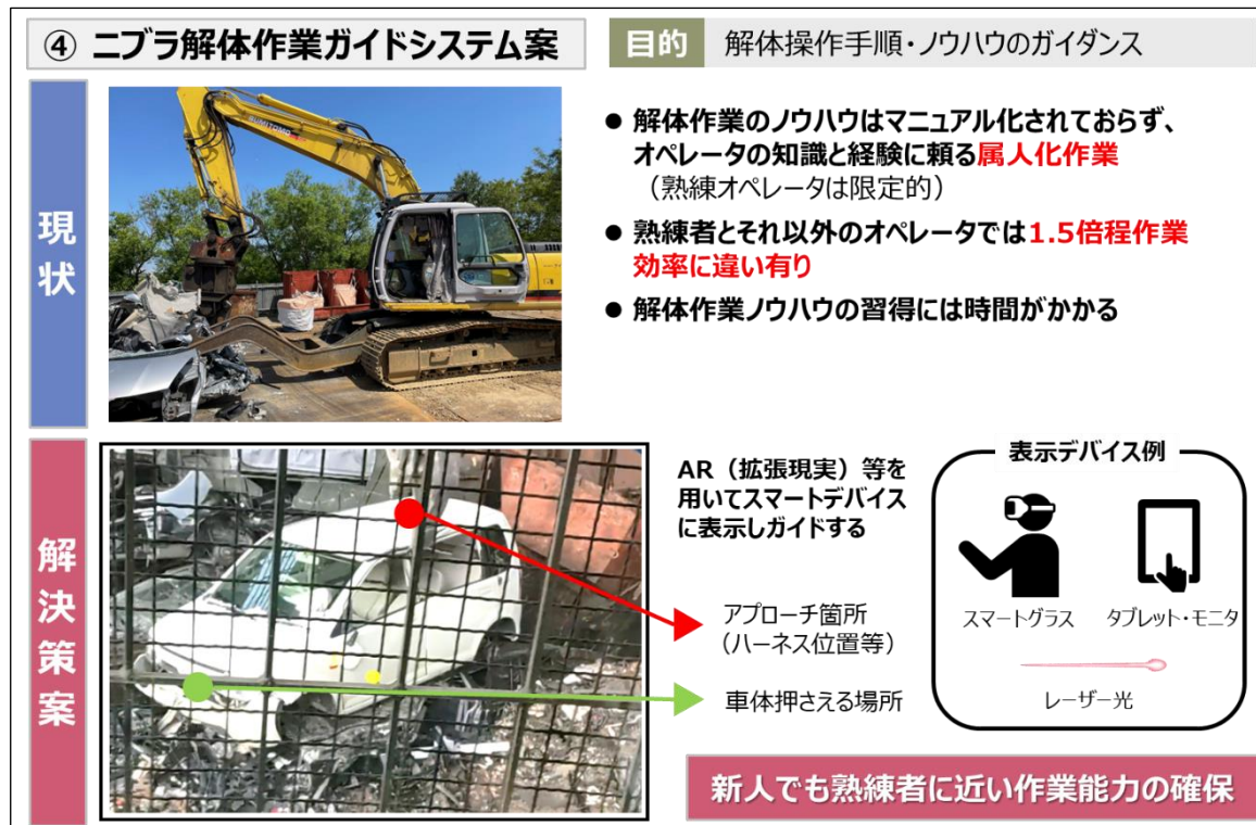
図5 ニブラ解体作業ガイドシステム
