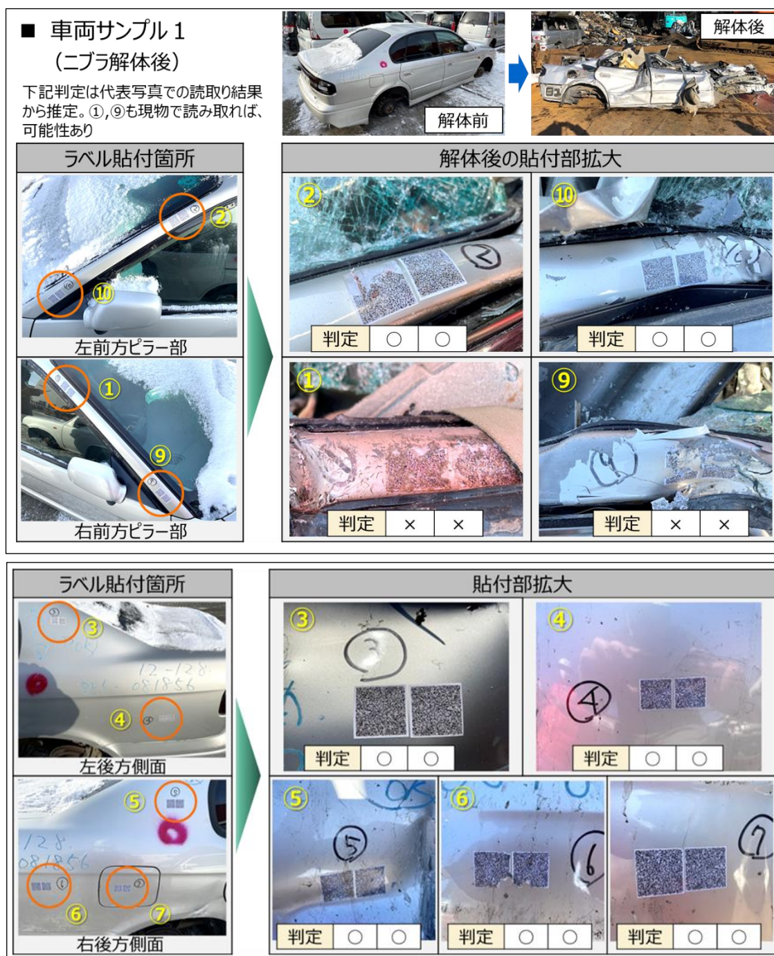
図 1 2 ニブラ解体作業後のデジタルマーク貼付け状況
