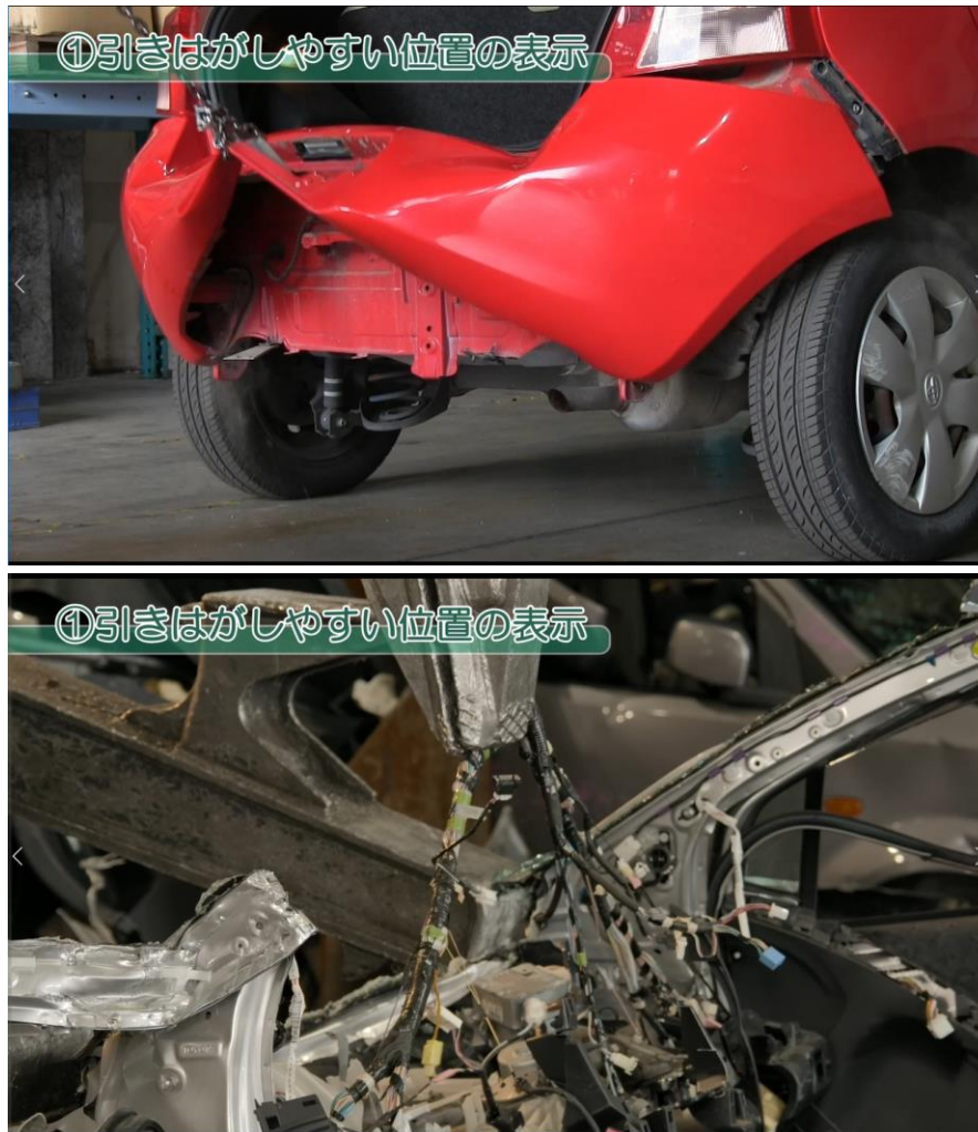
図 2-13 リサイクル設計を活用して解体する様子 (上：解体性向上マーク（バンパー）、下：解体性向上テープ（ワイヤーハーネス）)
