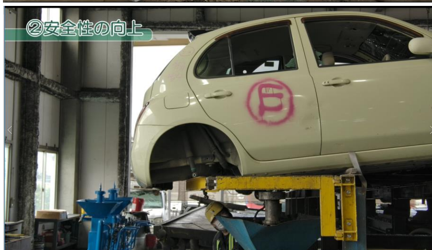
図 2-14 好事例を実際に活用する様子を紹介した動画 (上：解体重機の足を活用したハーネス付属部品回収、 下：燃料抜き時の落下防止対策バーの設置)
