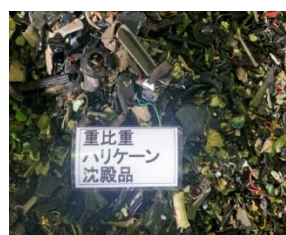
サンプル 2-2（試験条件①）の重比重 ハリケーン沈殿品
