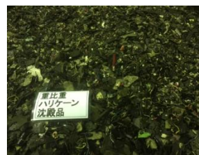
サンプル 2-3（試験条件④）の重比重 ハリケーン沈殿品
