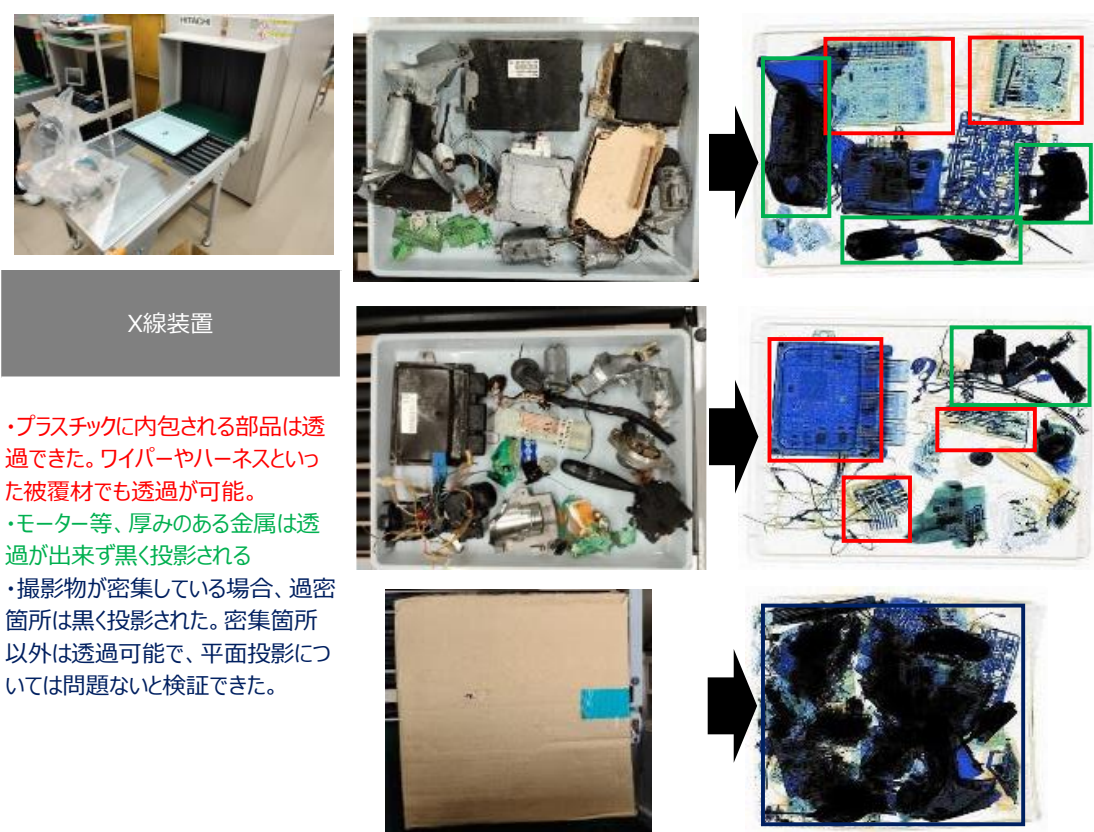
図 2-61. X 線装置による第 1 回試験の様子
