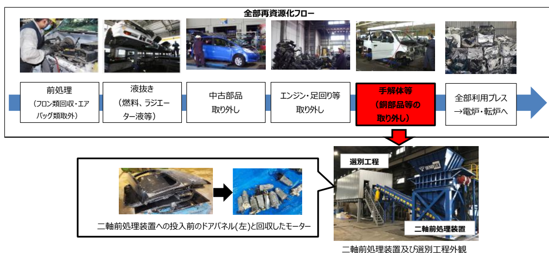
図 1-3.全部再資源化フローと二軸前処理装置及び選別工程
