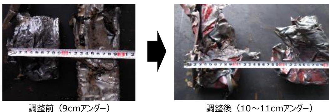
図 2-52.刃幅調整による処理材の変化
