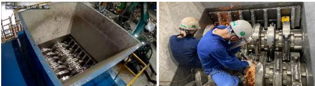
二軸前処理装置（刃部分）と刃幅調整作業の様子
