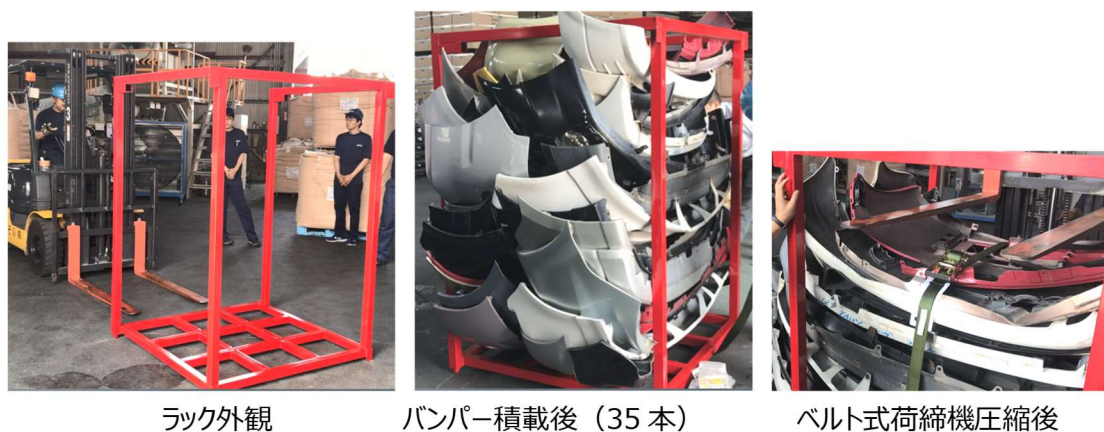
図 2.18. ラック積みの様子
