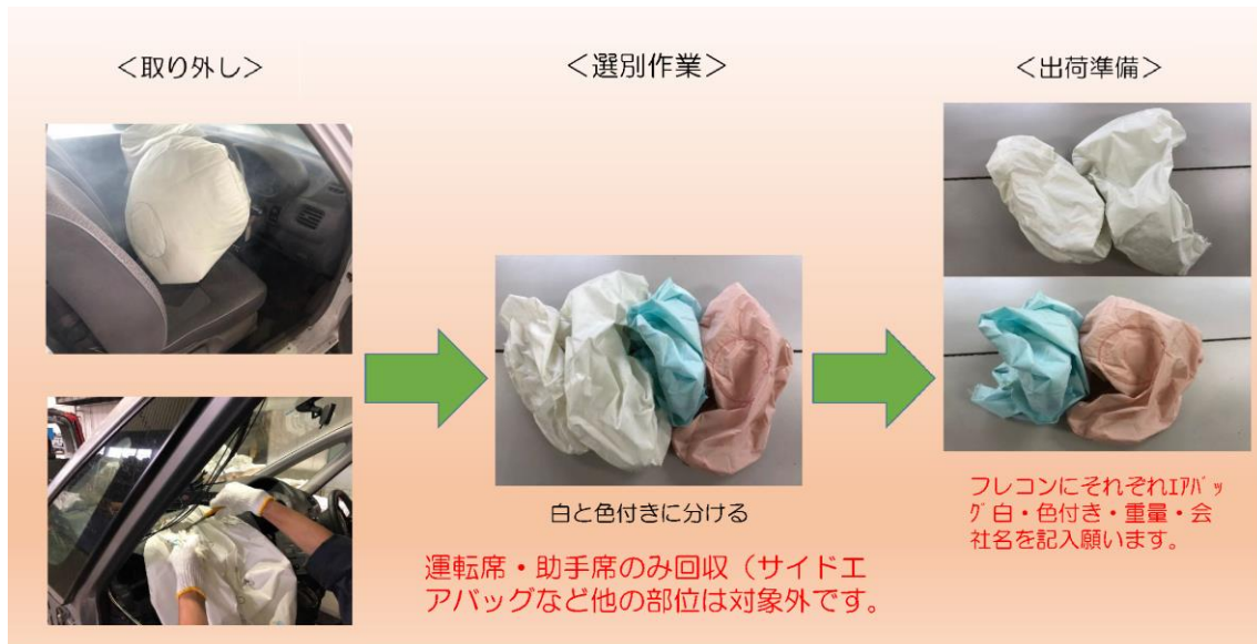
図 2-8 エアバッグ布の回収方法
