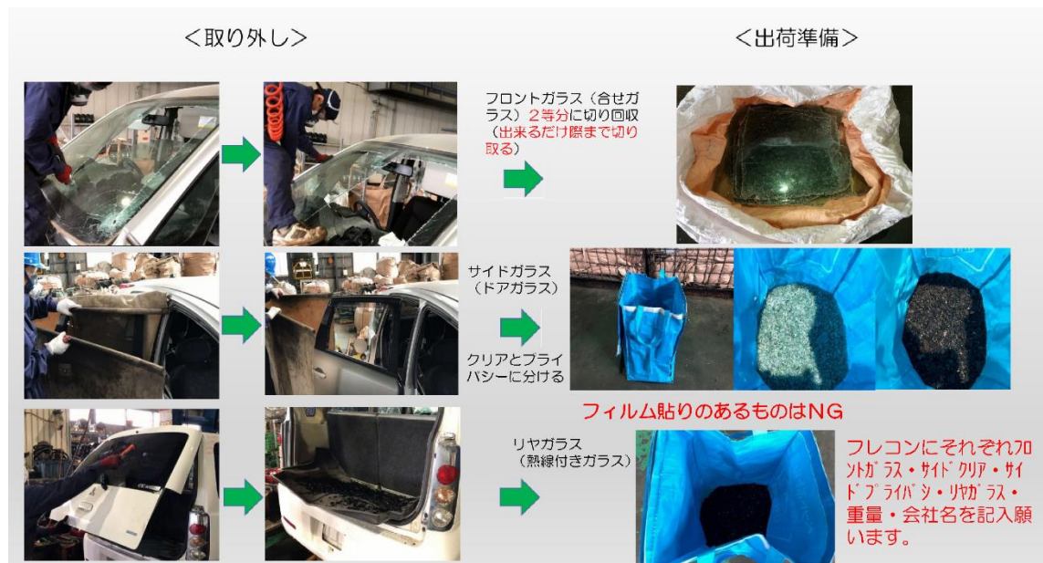
図 2-9 フロントガラス・サイドガラス・リアガラスの回収方法
