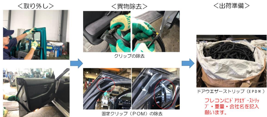
図 2-11 ドアウェザーストリップ(EPDM)の回収方法
