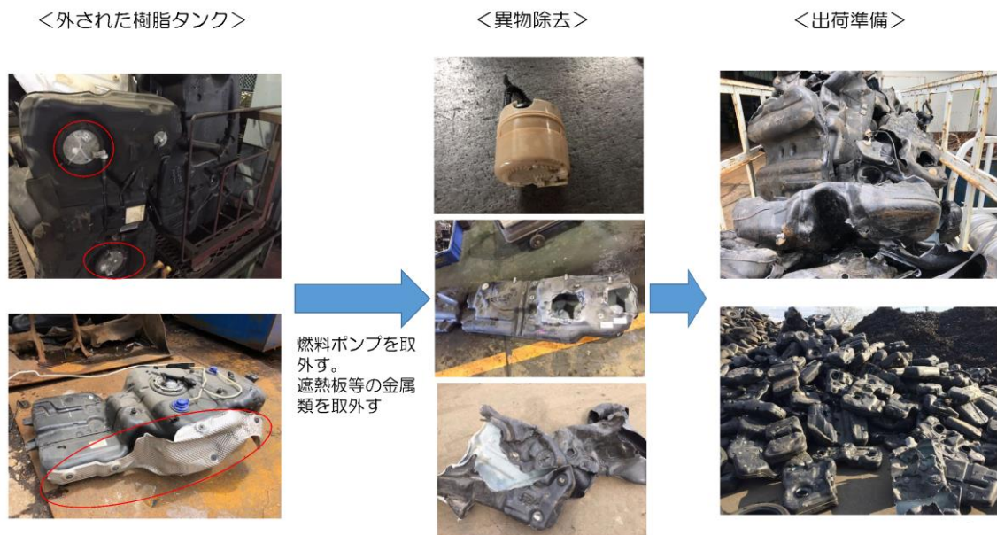
図 2-10 燃料タンク(PE 等)の回収方法
