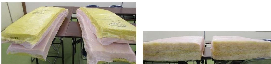
図 2-34 完成製品の比較(左:自動車ガラス、右:板ガラス製品)
