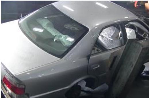
【専用設備で車両を横に倒す】
