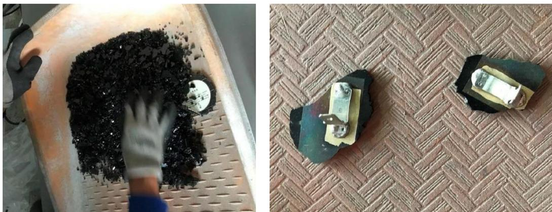
図 2-27 手選別での作業（左）と除去した異物の例（右：熱線の端子）
