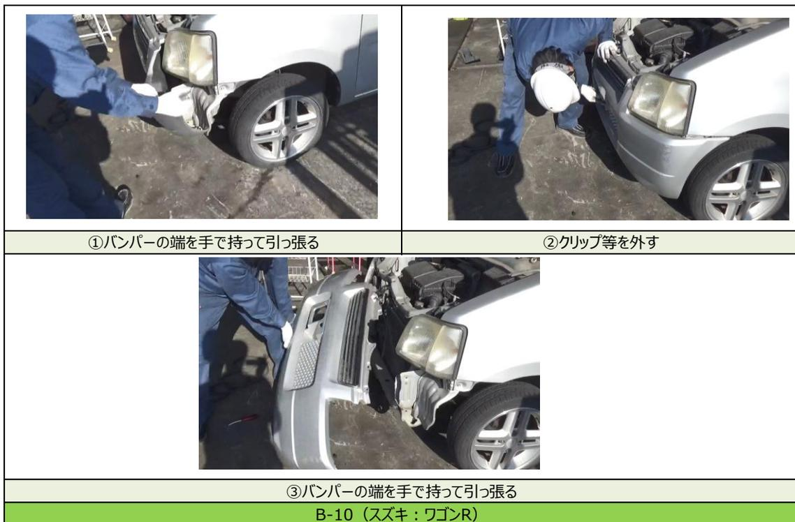
図 2-31. バンパーの 1 次解体 (手解体) で解体時間が短い例
