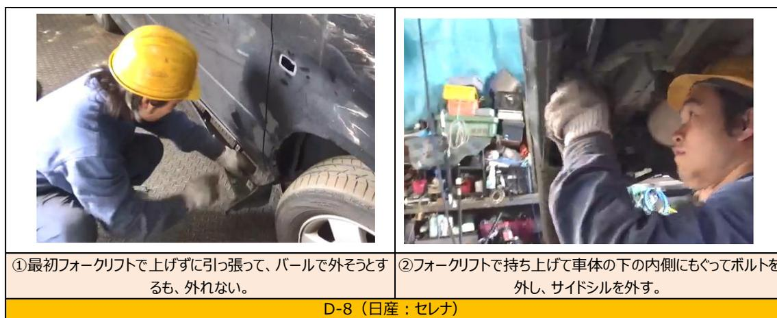
図 2-41.サイドシルガーニッシュの車体を持ち上げずに解体しようとした例
