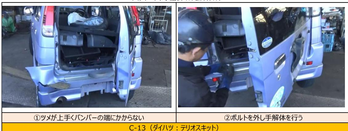
図 2-34. バンパーの 1 次解体（手解体）で解体時間が長い例
