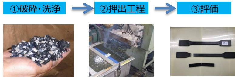
図 2-55.ペレット作成と物性評価工程
